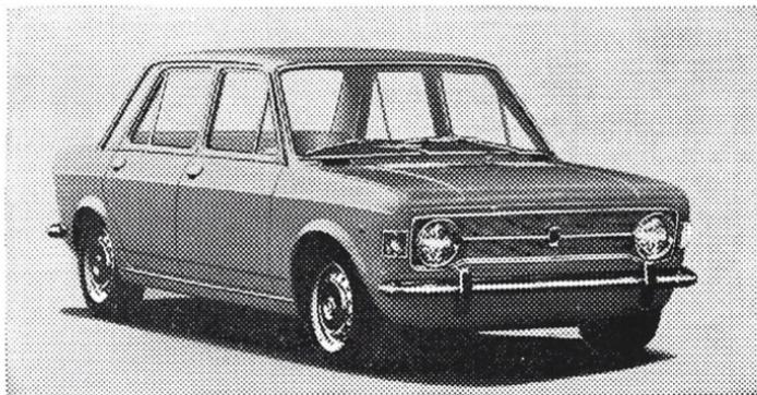
1115 ccm - 55 PS - Höchstgeschwindigkeit 140 km/h - fünffachge-
